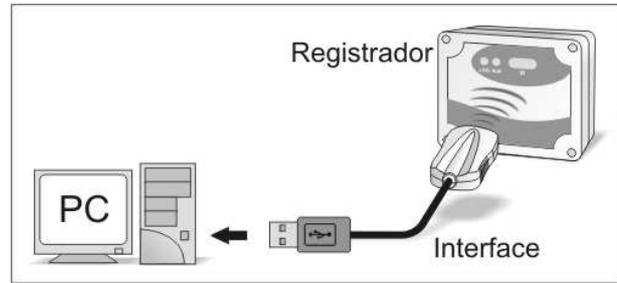
Figura 05 – Interface de comunicación dirigida para el registrador.
