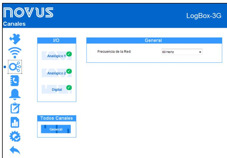
Fig. 14 – Pantalla de Entrada Digital: Configuraciones Generales
