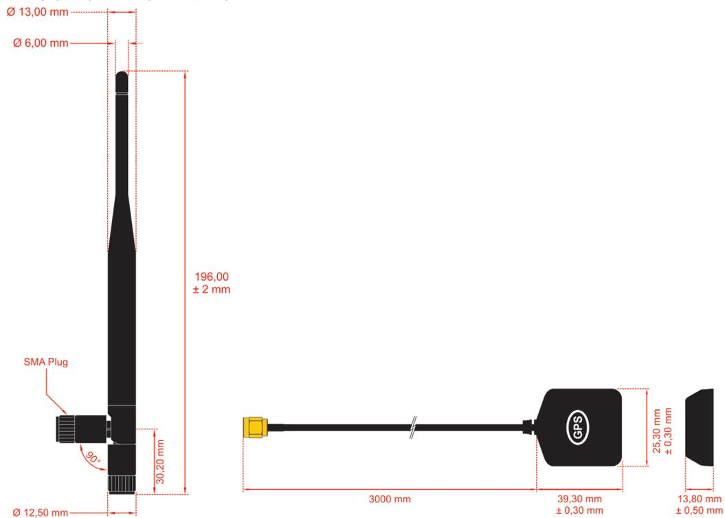
Fig. 36 – Dimensiones de las Antenas (Celular y GPS)
