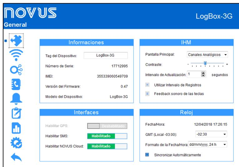
Fig. 08 – Pantalla de Configuraciones Generales
