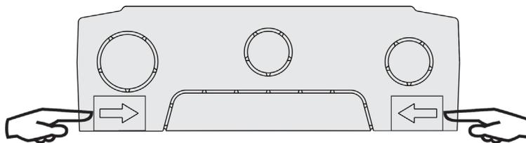
Fig. 34 – Encaje de la Tapa de Protección
