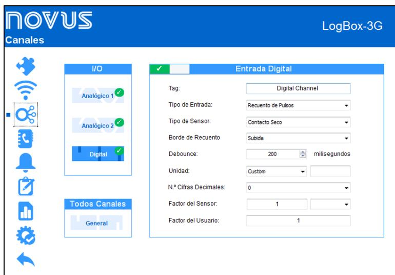
Fig. 12 – Pantalla de Entrada Digital: Modo Recuento de Pulsos
