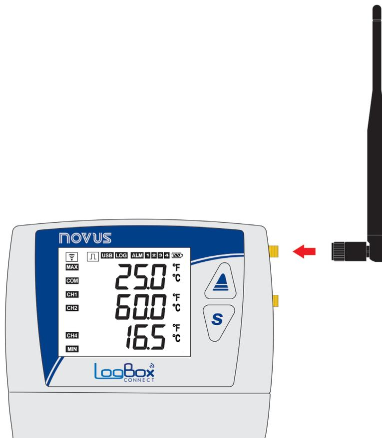
Fig. 37 – Antena de Telefonía Móvil
