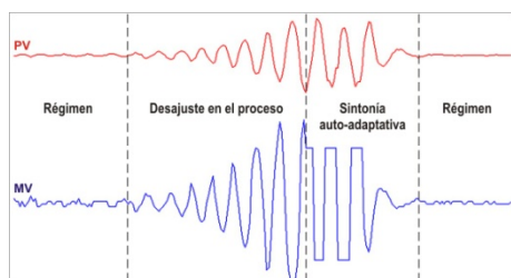
Fig. 04 – Ejemplo de una sintonía auto-adaptativa
