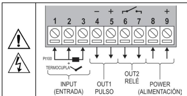
Fig. 01 - Conexiones de las entradas, salidas y alimentación
