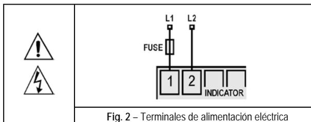
Fig. 2 - Terminales de alimentación eléctrica
