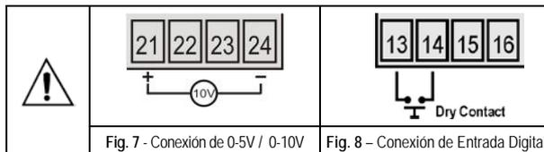
Fig. 7 - Conexión de 0-5V / 0-10V
