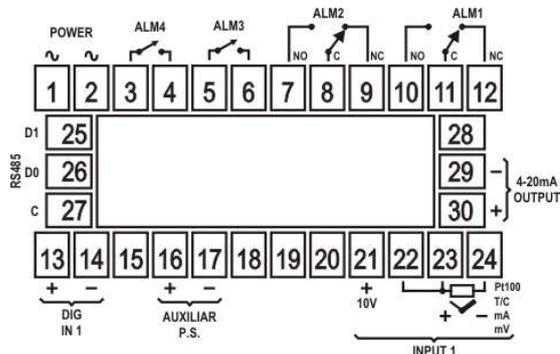
Fig. 1 - Conexiones del panel trasero
