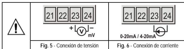
Fig. 5 - Conexión de tensión
