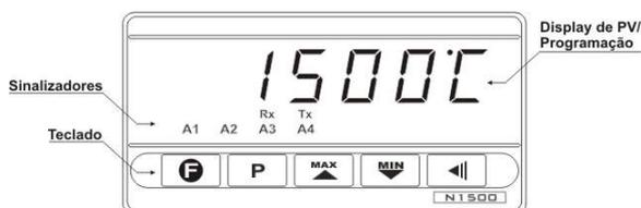
Fig. 10 - Identificación de las partes del panel frontal
