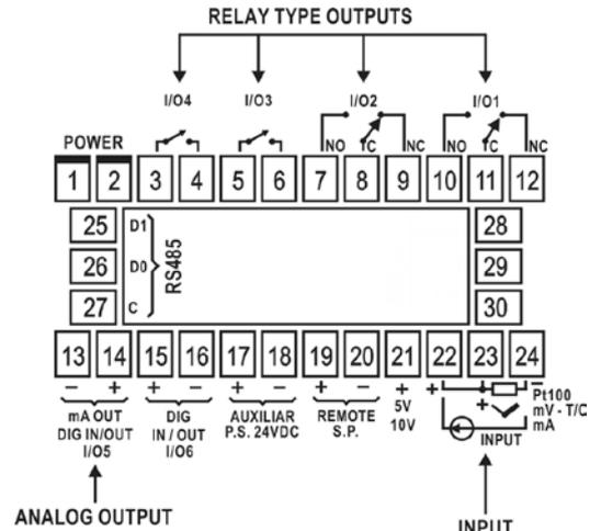
Fig. 1 - Conexiones del panel trasero.
