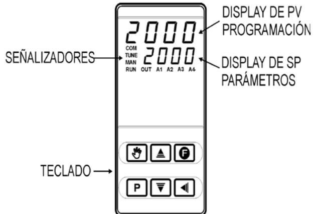
Fig. 8 - Identificación de las partes del panel frontal
