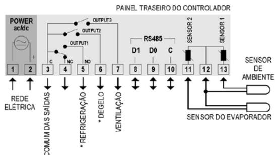
Fig. 1 – Conexiones mostradas en la etiqueta del controlador
