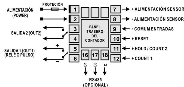
Figura 6 – Conexiones eléctricas traseras del NC400-6
