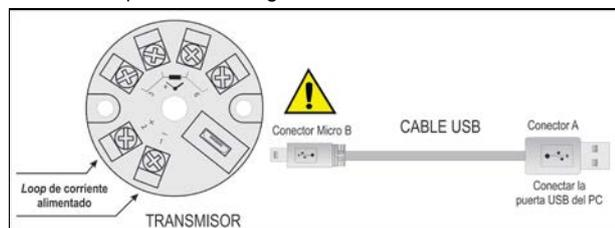
Fig. 2 – Conexiones del cable USB – Alimentación pelo *loop*
