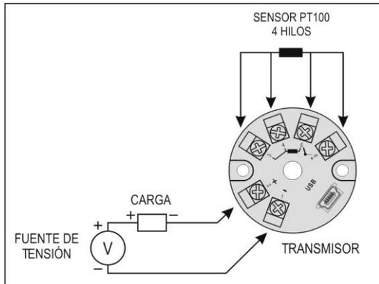
Fig. 7 – Conexiones eléctricas del transmisor (Pt100 4 hilos)
