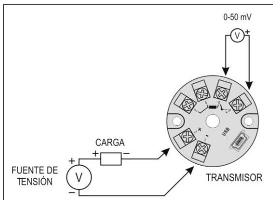
Fig. 9 – Conexiones eléctricas del transmisor (0-50 mV)
