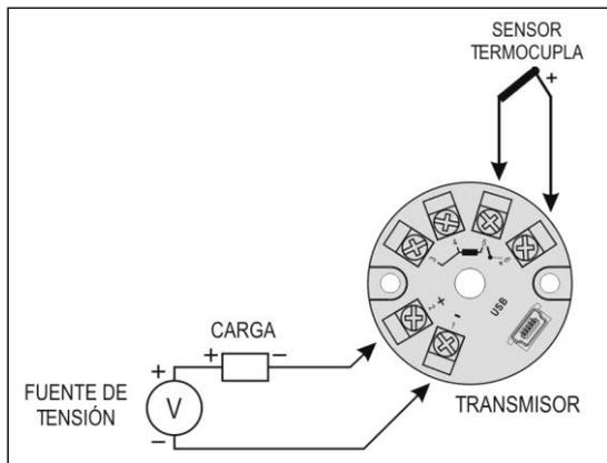
Fig. 8 – Conexiones eléctricas del transmisor (Termocupla)
