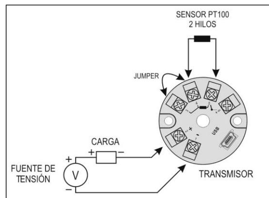
Fig. 5 – Conexiones eléctricas del transmisor (Pt100 2 hilos)
