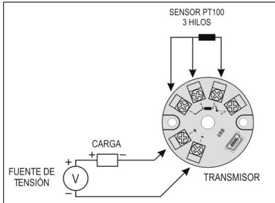
Fig. 6 – Conexiones eléctricas del transmisor (Pt100 3 hilos)
